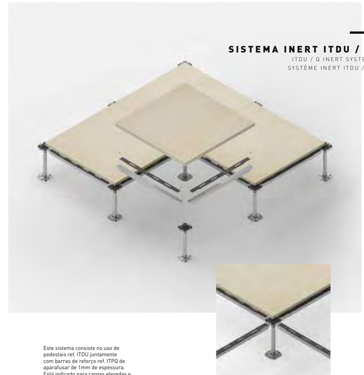
Este sistema consiste no uso de pedestais ref. ITDU juntamente com barras de reforço ref. ITPQ de aparafusar de 1mm de espessura. Está indicado para cargas elevadas e em situações em que as exigências de resistência ao fogo ou humidades sejam essenciais.
