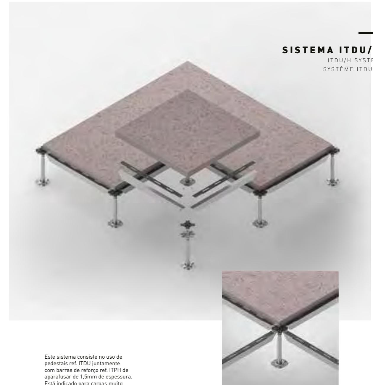
Este sistema consiste no uso de pedestais ref. ITDU juntamente com barras de reforço ref. ITPH de parafusar de 1,5mm de espessura. Está indicado para cargas muito elevadas.
