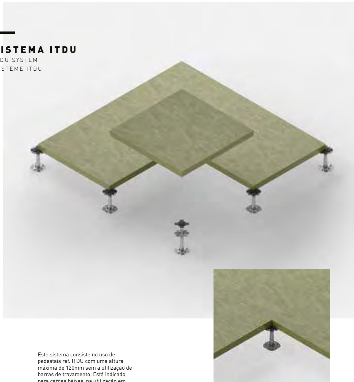
Este sistema consiste no uso de pedestais ref. ITDU com uma altura máxima de 120mm sem a utilização de barras de travamento. Está indicado para cargas baixas, na utilização em zonas de pouco tráfego sem qualquer tipo de cargas pontuais elevadas.
