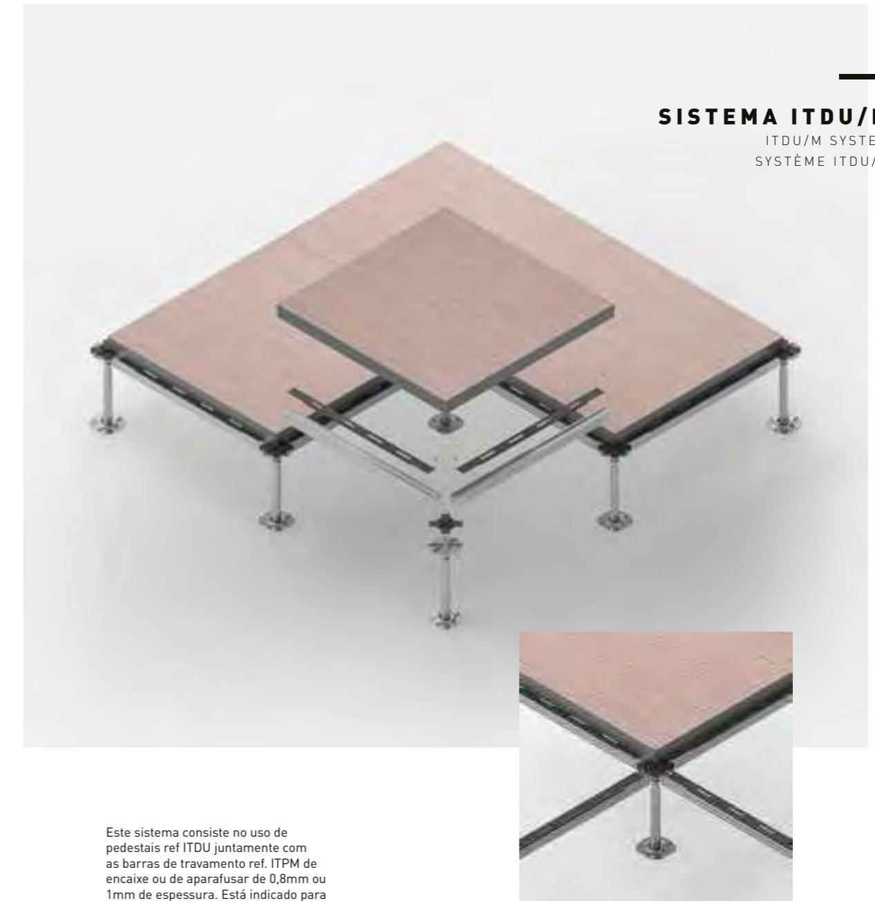
Este sistema consiste no uso de pedestais ref ITDU juntamente com as barras de travamento ref. ITPM de encaixe ou de aparafusar de 0,8mm ou 1mm de espessura. Está indicado para cargas médias altas.
