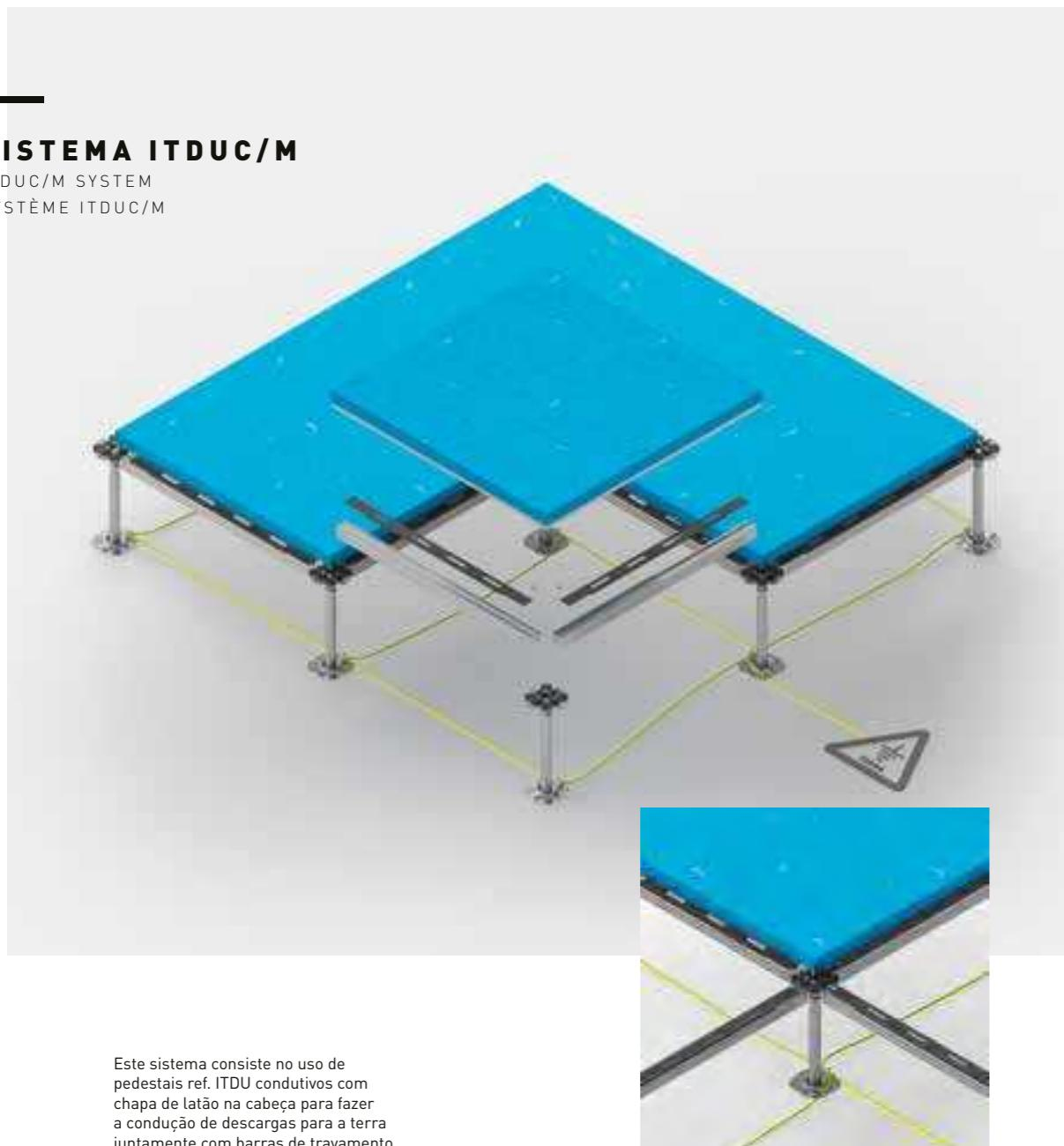
Este sistema consiste no uso de pedestais ref. ITDU condutivos com chapa de latão na cabeça para fazer a condução de descargas para a terra juntamente com barras de travamento ref. ITPM de encaixe ou aparafusar de 0,8mm ou 1mm de espessura. Está indicado para um sistema condutivo para cargas médias altas.
